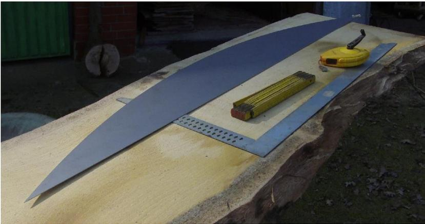
**WICHTIG!** Die gerade Seite der Kufen wird in einem Neigungswinkel von 15 Grad gesägt, um durch stabileren Stand ein Umschlagen der Wippe zu vermeiden! Diesen Winkel gilt es auch beim Anpassen des Mittelklotzes genau einzuhalten.
